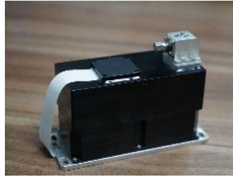
图22. 20W级一体化、小型化白光激光模组
