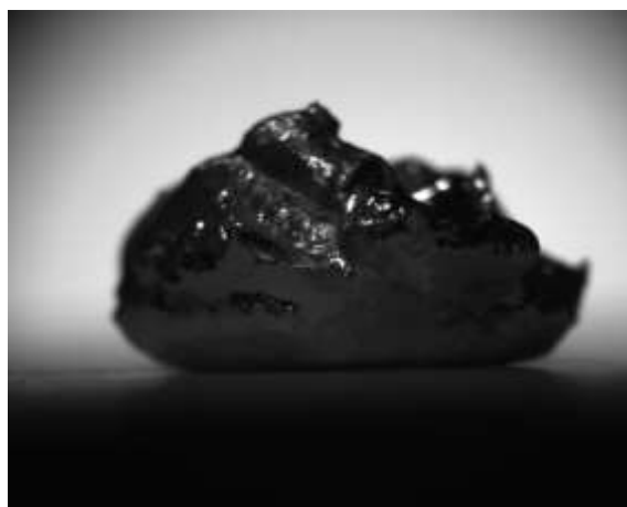
图 32. 液态金属与金属颗粒混合后形成的粘稠多相介质
