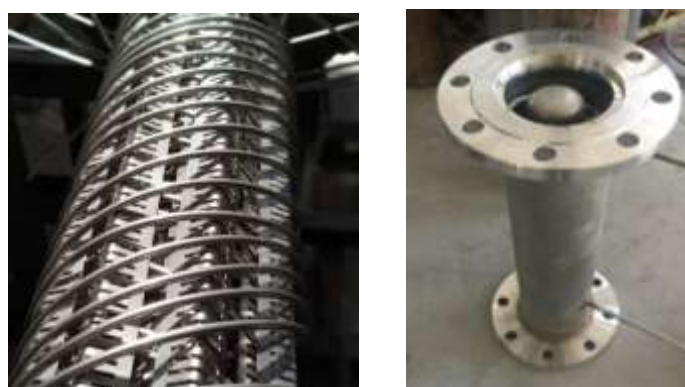
图 25. 新型提馏段内部换热结构局部图及整体图
