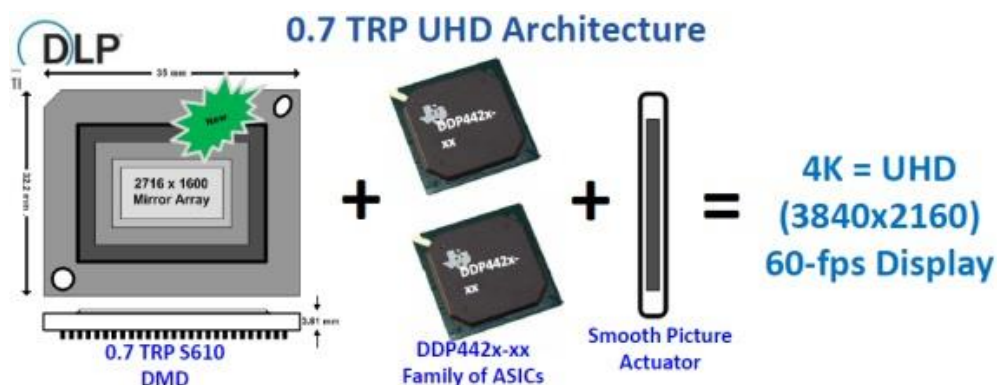
图 14. DMD 系统架构图
