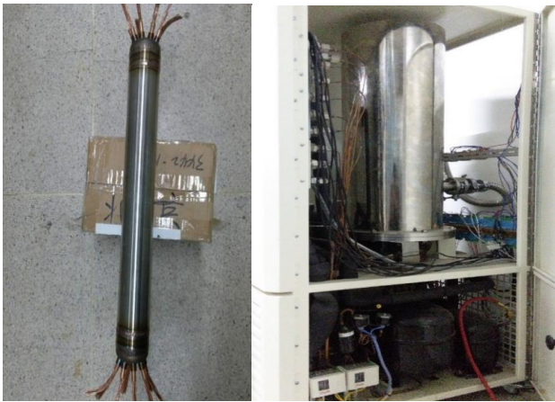
图 28. 多股流绕管换热器实物图
