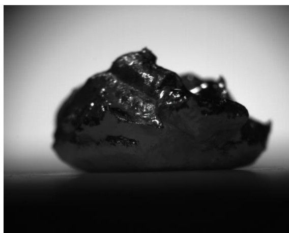
图 20. 液态金属与金属颗粒混合后形成的粘稠多相介质
