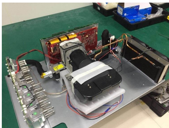
图 16 4K 超高分辨率三基色 LD 原理样机
