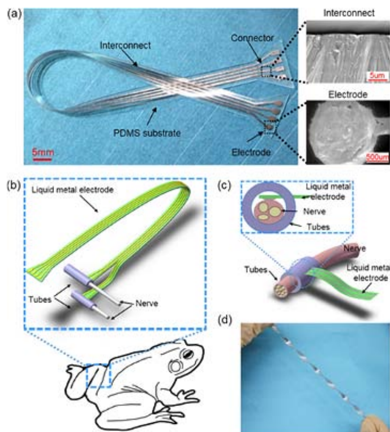
图 14 液态金属神经微电极及其结构示意图
