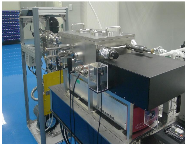
图 4 第 4 台 177.3nm DUV-DPL 激光样机
