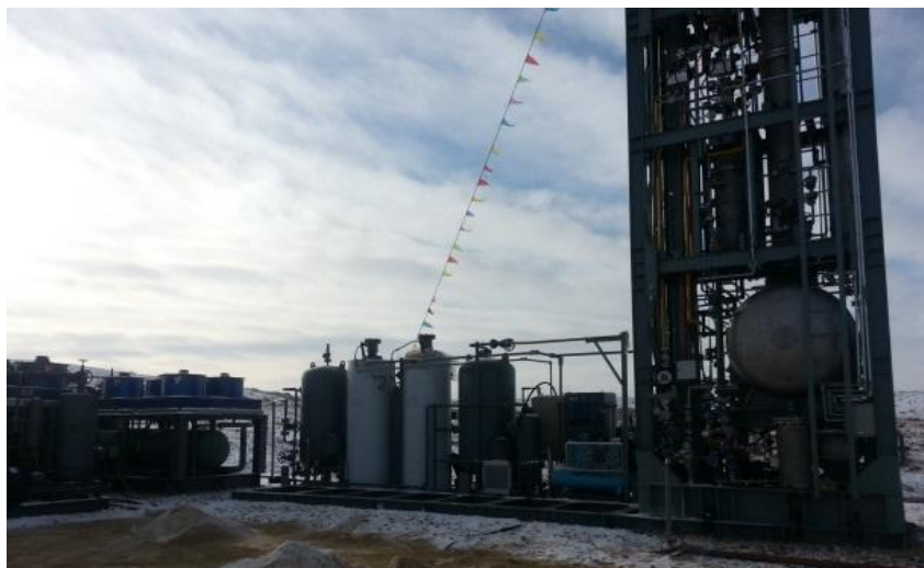
图 3. 研发的日处理 3 万天然气液化装置
