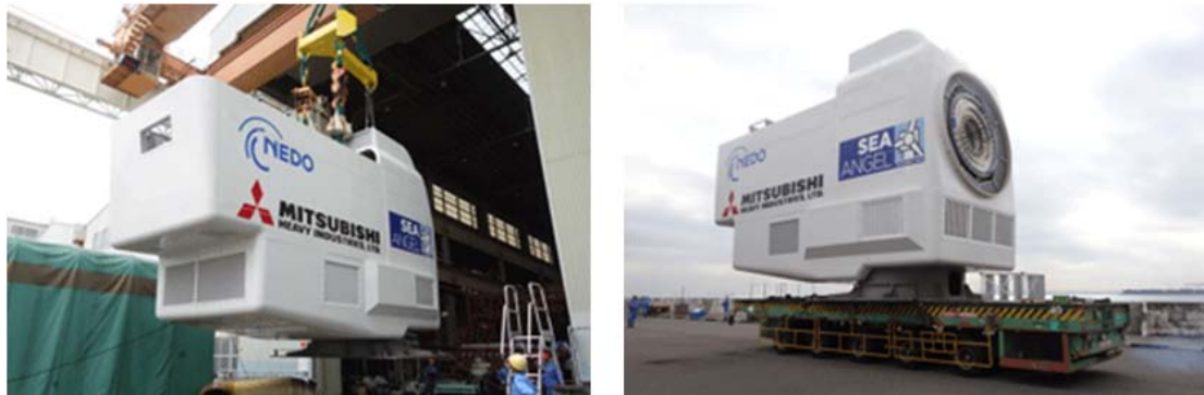
图 1 三菱重工的液压传动系统型风力发电系统(机舱)
